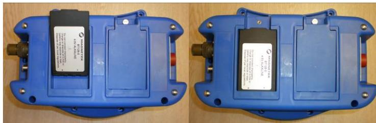
**Figura 4: Instalación del paquete de baterías en el transmisor XLTX**
