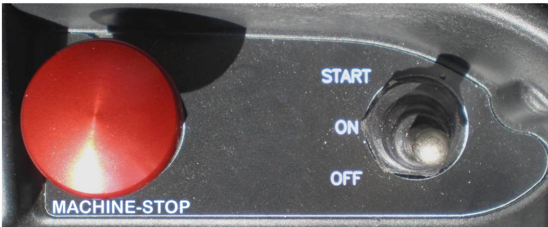
**Figura 10: Interruptor de parada de la máquina y conmutador OFF-ON-START (APAGADO-ENCENDIDO-ARRANQUE)**
