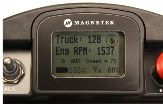
**Figura 11: Pantalla de funcionamiento normal en la interfaz gráfica de usuario del XLTX**
