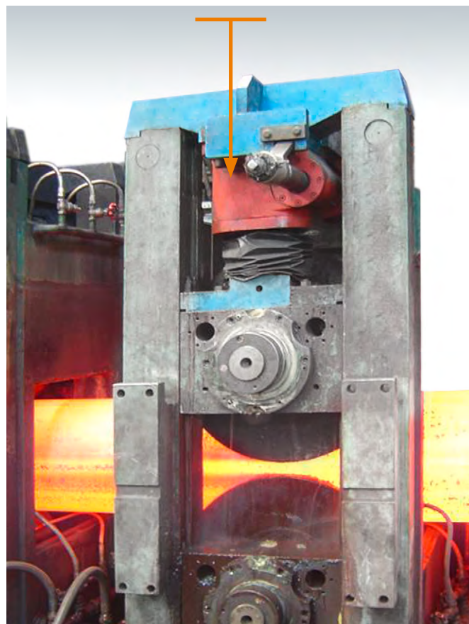
Hubelemente zur Rollenkalibrierung in einem Rohrwalzwerk
