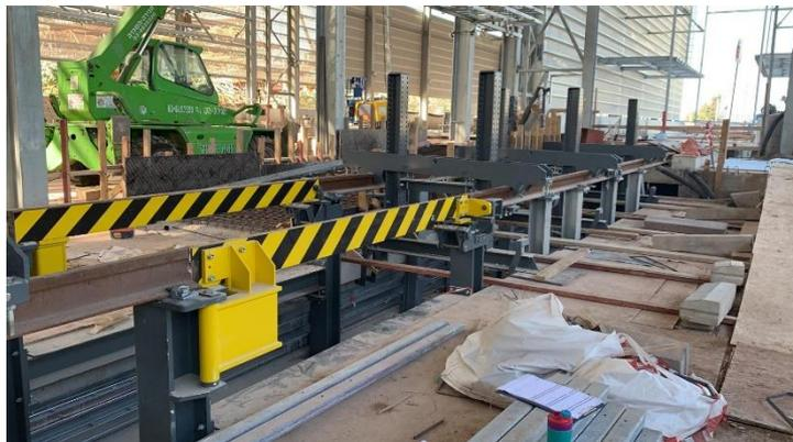
Gleisbrücken für Radsatzwechselsystem
