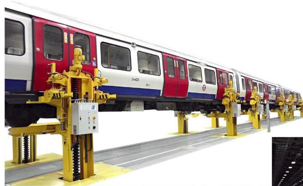
Synchronisiertes Heben von 8
