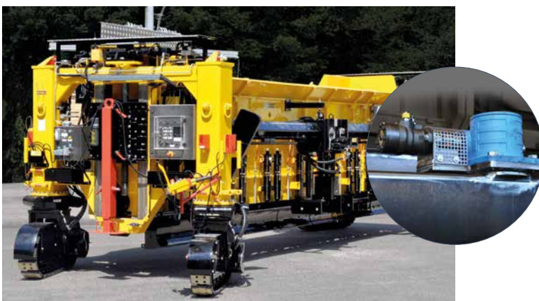
Spindelhubelemente Baureihe SHE von Pfaff-silberblau sorgen in den neuesten Einbauböhlen eines weltweit agierenden Maschinenbau-Unternehmens für einen zuverlässigen Betrieb.
