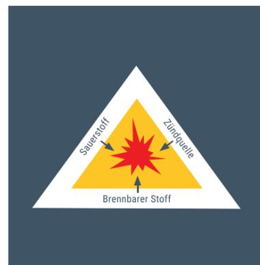
In technischen Anlagen können Explosionsgefahren entstehen, wenn drei Faktoren zusammenkommen: ein brennbarer Stoff (in entsprechender Verteilung und Konzentration), Sauerstoff (in der Luft) und eine Zündquelle. Brennbare Stoffe können Gase, Nebel, Dämpfe oder Stäube sein. Bei einer Schlagwetterexplosion im Bergbau wird eine explosionsfähige Atmosphäre aus Methan, Sauerstoff und feinem Kohlestaub durch etwa einen elektrischen Funken entzündet, in Mühlen
