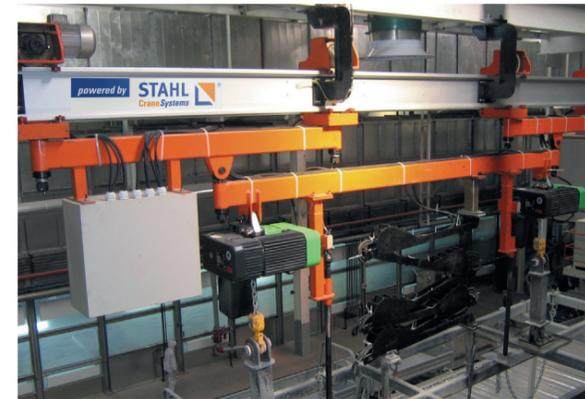
In einer Beschichtungsanlage für die Automobilindustrie in China arbeiten 48 speziell ausgeführte ST Kettenzüge bei sehr hoher Luftfeuchtigkeit.
