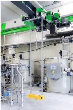
Der Einträger-Hängekran, realisiert mit dem CraneKit von STAHL CraneSystems (Bildquelle: Summer Metalltechnik)
