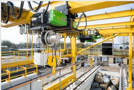
Dieser Seilzug ist dafür entwickelt worden, den Wissenschaftlern mit seinen schnellen, präzisen Hubbewegungen beim Bau der Test-Deiche zu helfen.
