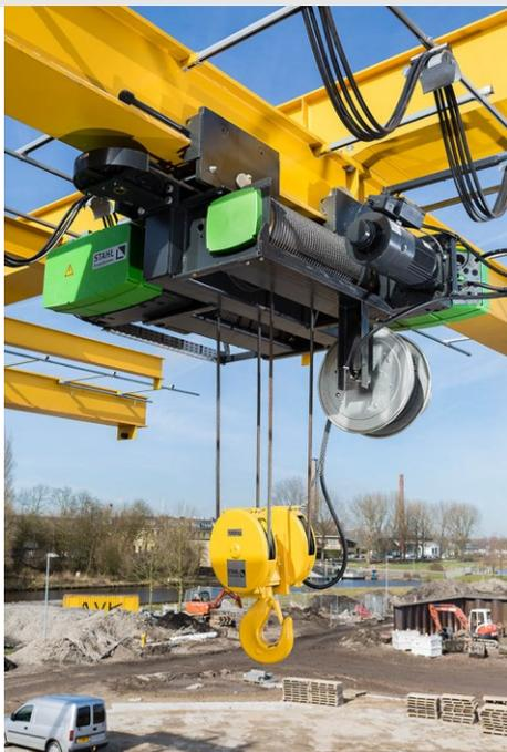
Der Seilzug SH als TwinDrive-Konzept vereint eine hohe Einstufung von FEM 3m und Hubgeschwindigkeiten von bis zu 25 m/min mit einer sehr geringen Bauhöhe. Die Führungsrolle sitzt waagrecht neben dem Seilzug (oben links im Bild).
