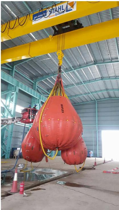
Für den Lasttest werden an den Kran mit Wasser gefüllte Big-Bags gehängt. Auch mit der 1,25-fachen Nennlast muss der Kran zur Abnahme sicher funktionieren.
